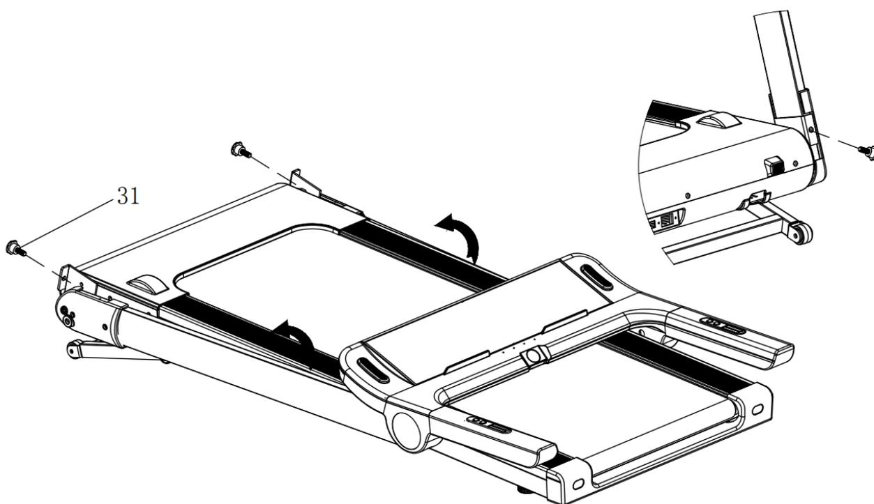
Поднимите консоль (см. рисунок ниже), используйте болт М8 (31) и плоскую шайбу, чтобы плотно зафиксировать консоль.
